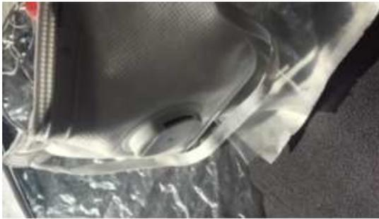
Ausatemventil einer FFP 2 Maske in der Außenansicht, Plastikkappe schützt Gummimembran
