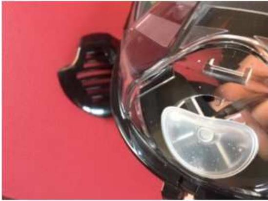
Geöffnetes Ausatemventil einer Schnorchelmaske, Abdeckung entfernt (im Hintergrund)
